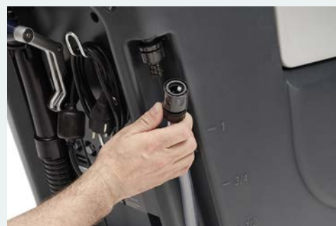
Le flexible de solution est facile à déconnecter et le réservoir de solution peut être rempli d'eau rapidement
