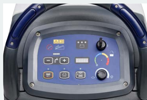
La régulation du débit de solution peut s'ajuster depuis le poste de conduite selon le type de sol et le niveau de saleté
