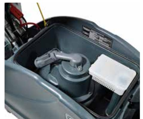
Réservoir de 44 litres permettant un temps de travail de 75 minutes
