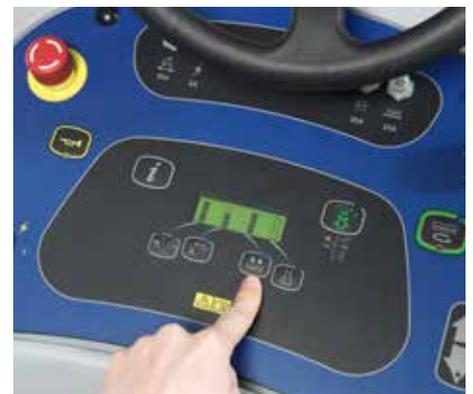
Deux niveaux de pression de brosse, la 1ère pour un nettoyage standard et la 2ème pour les applications où une performance de nettoyage supérieure est nécessaire
