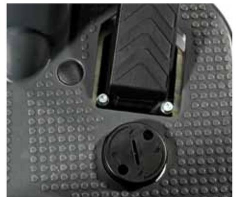
Nouvelle pédale avec système de talon réglable (breveté) pour éliminer toute tension au niveau du pied de l'opérateur
