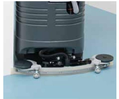
Nouveau système de bloc de lavage (relié au volant) : lorsque vous faites tourner le volant à gauche, le plateau bouge aussi sur la gauche (c'est la même chose du côté opposé) ; cela garantit des performances de nettoyage optimales avec un grand confort et un minimum d'efforts. Le chemin de lavage est complètement couvert par l'embouchure et il est inutile d'utiliser des jupes latérales.
