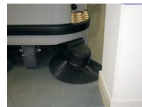
Balais latéraux escamotables sous le châssis
