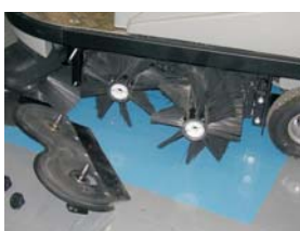
Système breveté de deux brosses centrales
