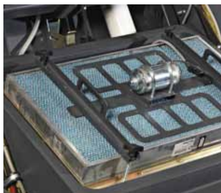
Le secoueur de filtre Multispectrum™, dont le brevet est en cours, permet un nettoyage total du filtre.
